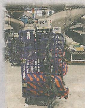
▲LSCM研發中心為香港郵政的空運中心設計RFID郵件處理系統。在運送郵件的載貨車加設電子顯示器作辨識。
